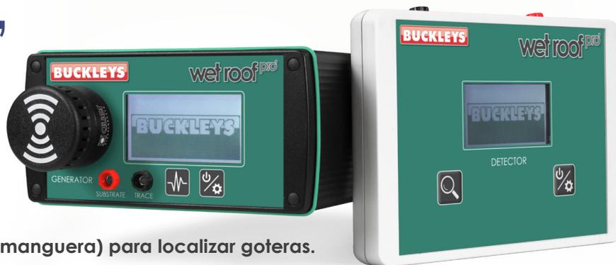
El kit consta de dos elementos principales: una unidad generadora y una unidad detectora. La unidad generadora crea un campo eléctrico por la superficie del tejado mediante un «cable delimitador» que se coloca alrededor del perímetro de la zona que se comprueba y se conecta al terminal positivo de la unidad generadora. El terminal negativo se conecta a una toma de tierra adecuada en la estructura del edificio.
