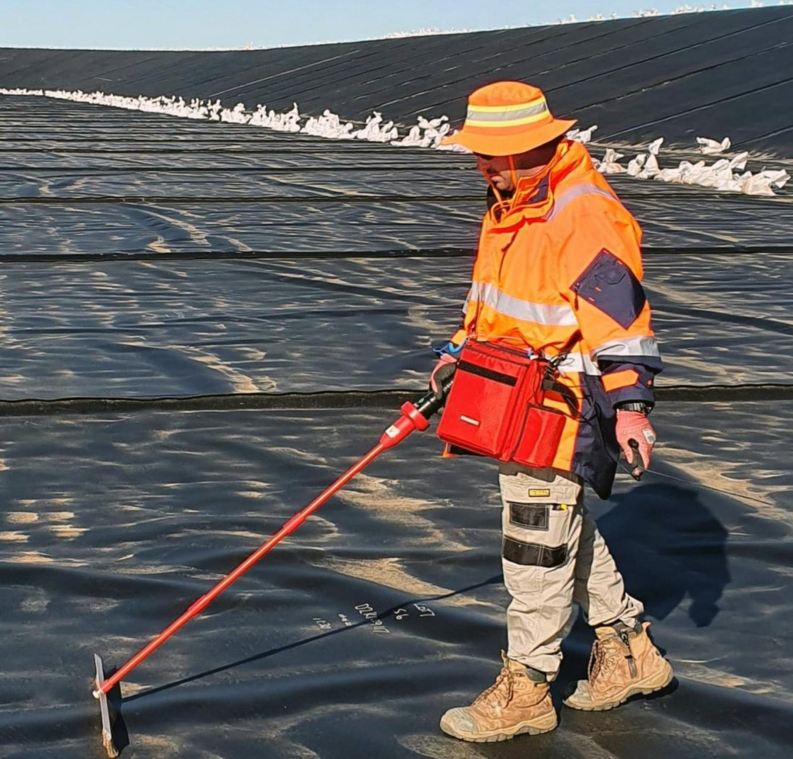
prueba de defectos en geomembranas
