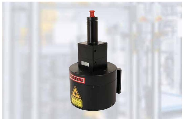
Con el Radial Optic, la soldadura láser sin rotación es posible sin tecnología de sujeción adicional. La soldadura radial es adecuada para los componentes simétricos de rotación que son difíciles de rotar por sí mismos. La radiación láser es desviada sobre la circunferencia de los componentes por un espejo cónico. Esto permite soldar simultáneamente componentes con un diámetro de hasta  $\varnothing$  68 mm alto rendimiento y ciclos cortos.
