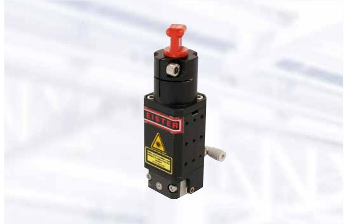
El Roller Optic no requiere ninguna tecnología de sujeción adicional. Con el Roller Optic un rayo láser lineal es guiado a través de un rodillo de vidrio, que es tanto la herramienta de presión como el último elemento óptico. El rodillo, que se apoya en dos lados, puede producir un ancho de costura de soldadura de unos 3–6.7 mm. Debido al cojinete de péndulo del rodillo, se pueden compensar pequeñas irregularidades en la dirección axial.
