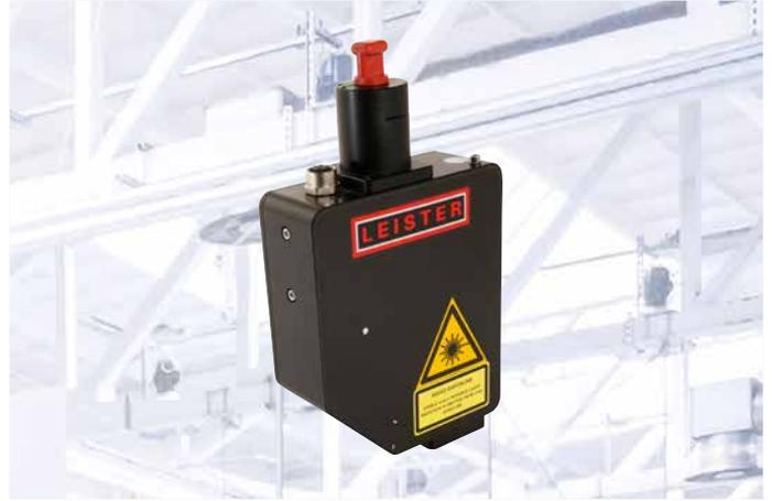
El Spot Optic enfoca el rayo láser a un punto y se utiliza principalmente para la soldadura de contorno. Las longitudes focales de las lentes de enfoque utilizadas determinan el diámetro del punto, que a su vez determina el ancho del cordón de soldadura. Por lo tanto, el rayo láser puede adaptarse a las necesidades individuales de la soldadura de plásticos mediante la sustitución de los componentes ópticos.
