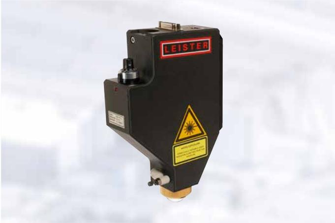
Con el Globo Optic la soldadura en 2D o incluso 3D es posible sin una compleja tecnología de sujeción. La bola de vidrio con soporte de aire enfoca la radiación del láser y también sirve para suministrar la fuerza de sujeción mecánica. A medida que la bola rueda sobre el componente, se presiona completamente y localmente en el plano de unión. Esto significa que la radiación láser sólo golpea donde hay presión de contacto.
