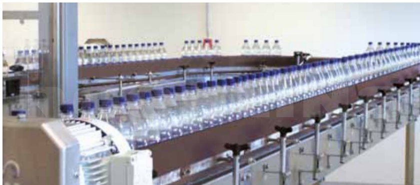
Sistema de transporte con piezas deslizantes de LubX® S y LubX® C Système de convoyage avec pièces de glissement en LubX® S et LubX® C
