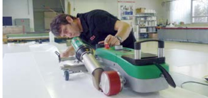
Sencilla soldadura de rebordes y burletes con el kit para rebordes y burletes.
