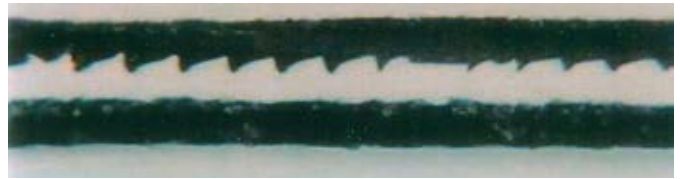
Con tobera de agarre, 25% mayor resistencia de las costuras de soldadura. Principalmente para las geomembranas de TPO.
