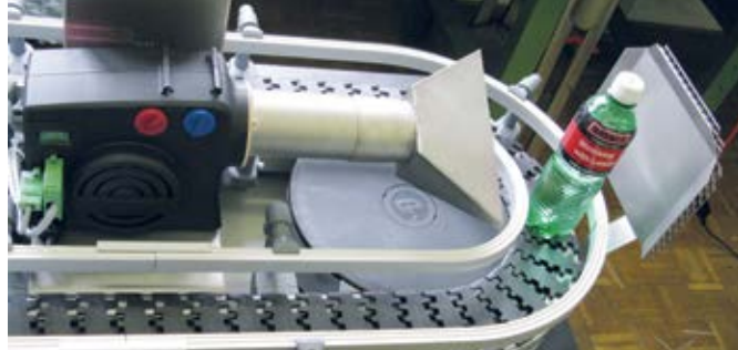
SISTEMA HOTWIND con boquilla de ranura ancha integrada en una aplicación de soplado.
